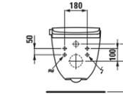
Соединение с системой инсталляции Laufen LIS CW2
